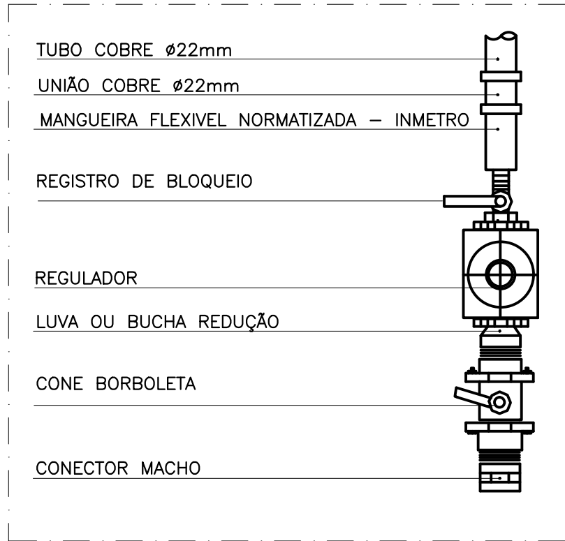
DETALHE LATERAL CONJUNTO VÁLVULA REGULADOR DE GÁS SEM ESCALA
