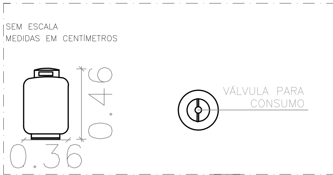
DETALHE DO CILINDRO DE GÁS P13
